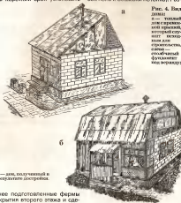
Рис. 2. Поэтажное возведение двухэтажного дома с верандой:
